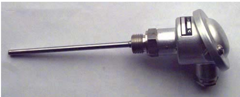
Bild 69: Industrielle Bauform eines Widerstands- Thermometers
